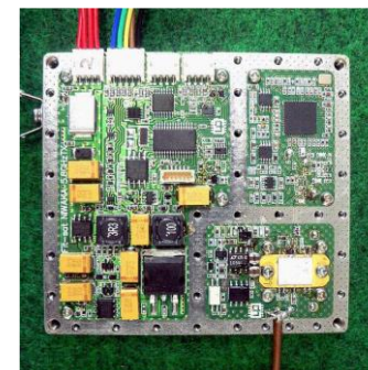
5R8G TX 5.84GHz ロジカル・プロダクト LPTX5840-1 (福岡工大FITSAT-1と同品)
