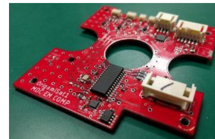
MDC (Membrane Devices Controller) 膜上ミッション
