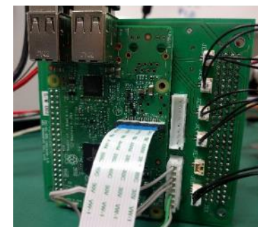
ECPB (Extensive Camera Power Board) +Raspberry Pi 伸展開カメラ部の電源制御 カメラ撮影
