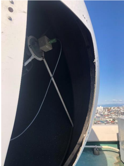
Tokyo Tech JQ1YCZ 5.8GHz antenna
